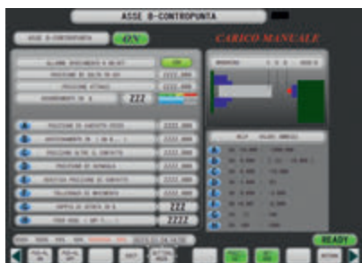
Schubkraftüberwachung durch das NC-Programm.
