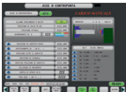
Controllo della spinta contropunta da programma.
