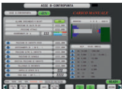
Contrôle de la poussée par le programme.
