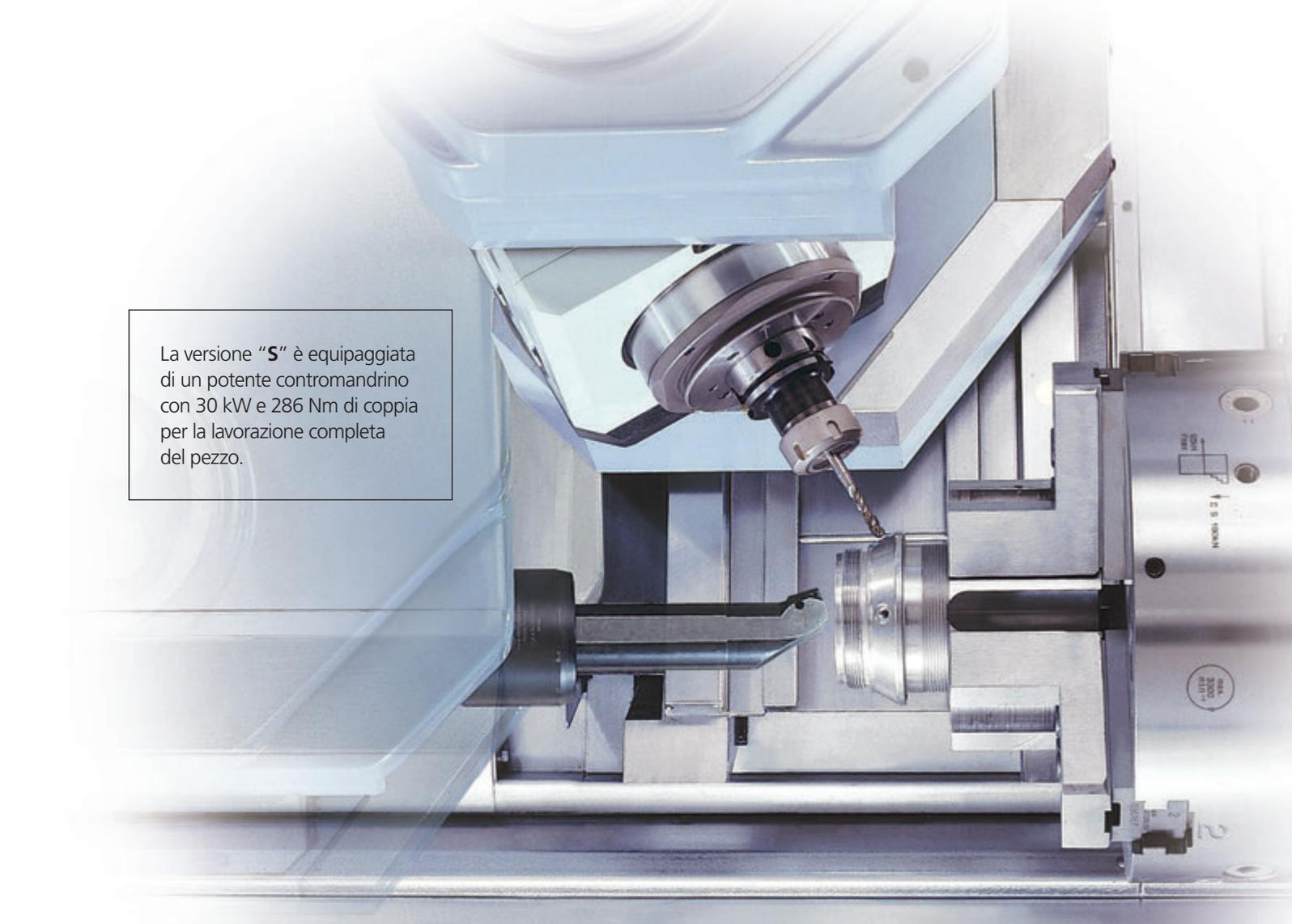
La versione "S" è equipaggiata di un potente contromandrino con 30 kW e 286 Nm di coppia per la lavorazione completa del pezzo.
